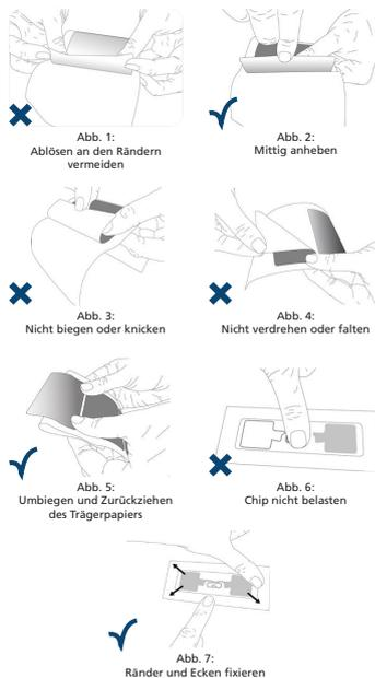
Achten Sie beim Verkleben darauf, dass sowohl die Oberfläche, wie auch das *smart-LABEL* Raumtemperatur (ca. 20°C) haben. Eine Repositionierung des RFID-Transponders nach der ersten Verklebung vermindert die Haftfähigkeit erheblich. Zudem können Beschädigungen der elektronischen Komponenten auftreten. Bei automatischer Verspandung ist auf eine optimale Bahnspannung und eine ausreichend scharfe Spendeckante zu achten.
